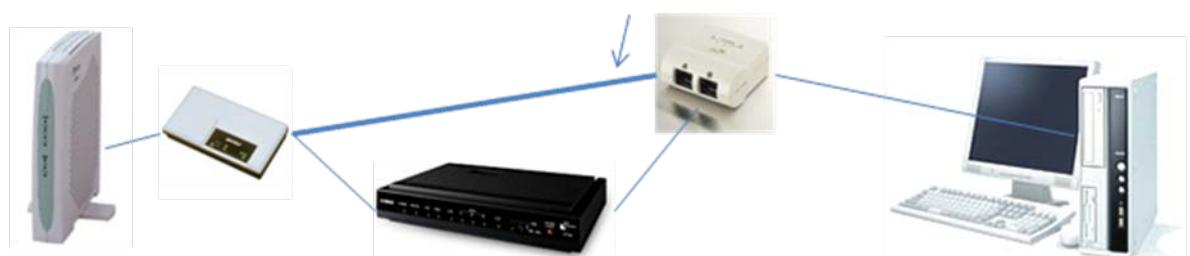
モデムの直下にハブを取り付け、ルーター経由接続のルートとモデム直接接続のルートを確保した。中間に「切り替えスイッチ」を入れてオンライン請求時にはモデム直接接続のルートを使用する。送信用 PC からでもレセコン直接でもこのルートの構築は必要となります。これらは我々の範疇ではないのでベンダーお任せとなります。
