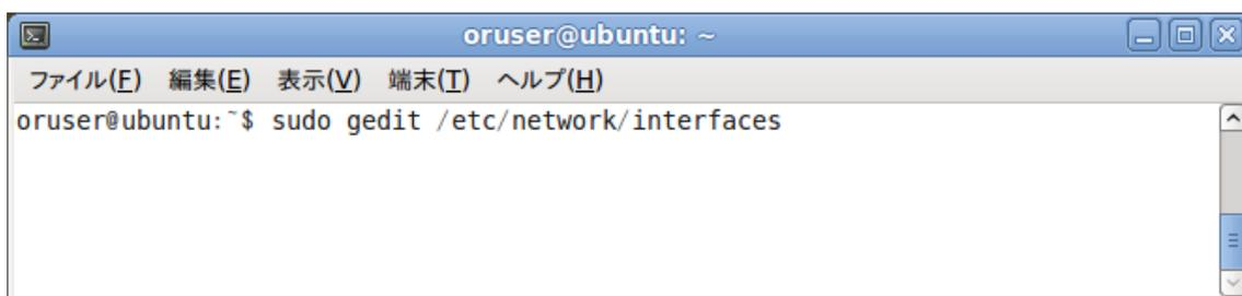
A terminal window titled 'oruser@ubuntu: ~' with a menu bar containing 'ファイル(E) 編集(E) 表示(V) 端末(T) ヘルプ(H)'. The command 'oruser@ubuntu:~\$ sudo gedit /etc/network/interfaces' is entered and displayed on the screen.
