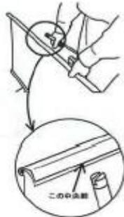
6. スナッププロフィールの中央部に芯棒先の溝を引っ掛ける
