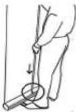
8. 芯棒下部を本体の穴に挿す(上部、下部両方の穴にしっかり深く挿す)
